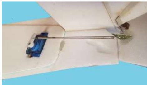
J'avais il y a quelques années construit un Zlin 526 suivant un plan modifié trouvé sur un MRA de 857. Le point faible de cette construction était les commandes de profondeur et de direction, la liaison trop souple, difficulté de réglage.
